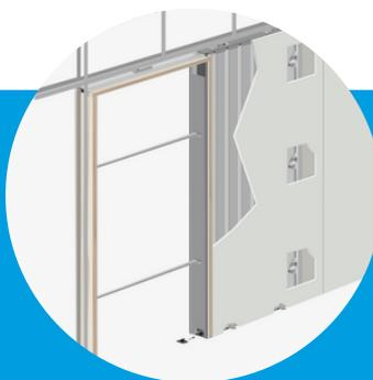
Montage cloison plaque de plâtre 100 ou 120
